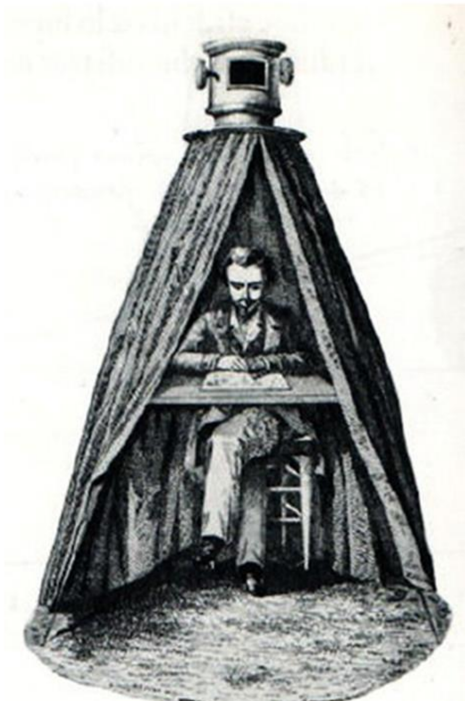
FIG. 4 – Um desenho de uma câmara obscura tipo tenda móvel Kepler - o tipo projetado por Kepler em 1620.
