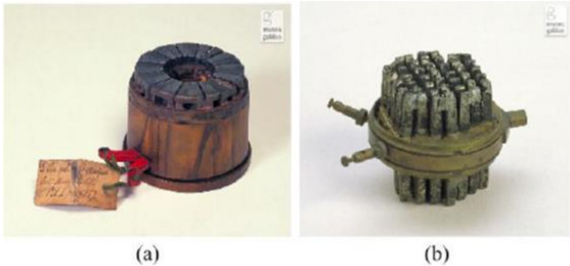
FIG. 12: As termo pilhas Nobili-Melloni: (a) protótipo da termo pilha inventada por Nobili, (b) versão incompleta da termo pilha Nobili-Melloni
