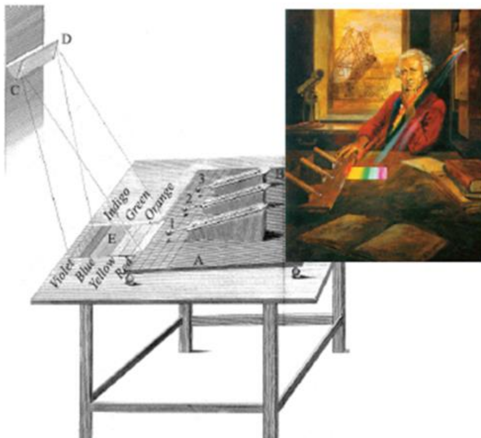
FIG. 11 – Primeiro experimento de Herschel: A, B – o pequeno suporte, 1,2,3 – os termômetros sobre ele, C, D – o prisma na janela, E – o espectro jogado sobre a mesa, de modo que colocar o último quarto de polegada da cor lida no suporte.
