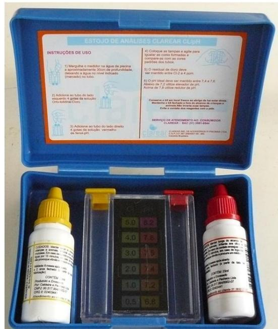
**Figura 13:** Imagem do estojo com o kit portátil de medição de cloro e pH na água.
