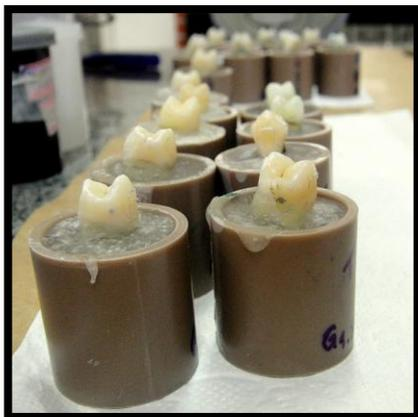
Figura 21: Espécimes após a fratura.
