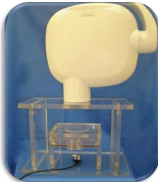
Figura 3. Posicionador utilizado para manter a distância foco-filme constante (40 cm).
