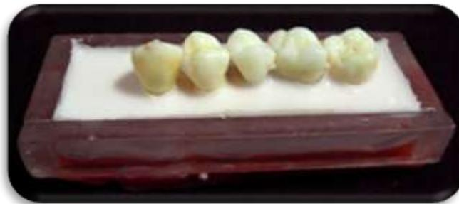
Figura 9. Matriz de acrílico vazada com silicone para construção dos *phantoms*.
