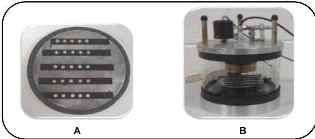
Figura 12. **A.** Corpos de prova colados na placa de platina com fita condutora de carbono dupla face. **B.** Metalizador Emitech K450.
