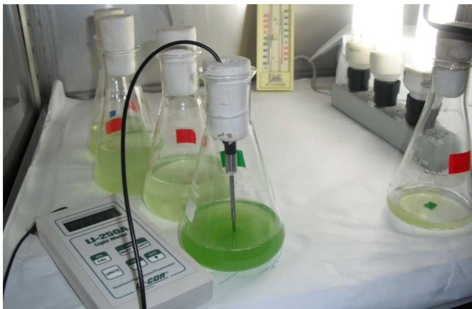
**Figura 7:** Determinação de PPF: O sensor esférico foi posicionado encontra-se no interior dos frascos, dentro das culturas.
