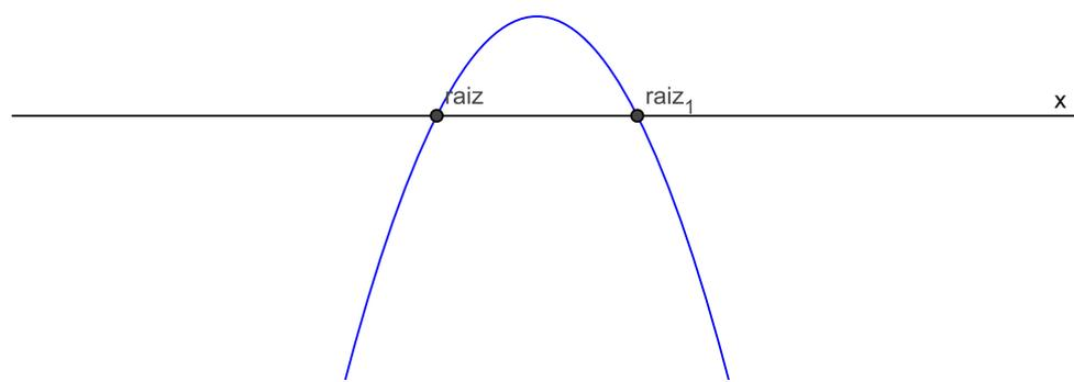
Figura 32 – Com  $a < 0$ ,  $\Delta > 0$ : duas raízes reais e diferentes, concavidade da parábola voltada para baixo.
