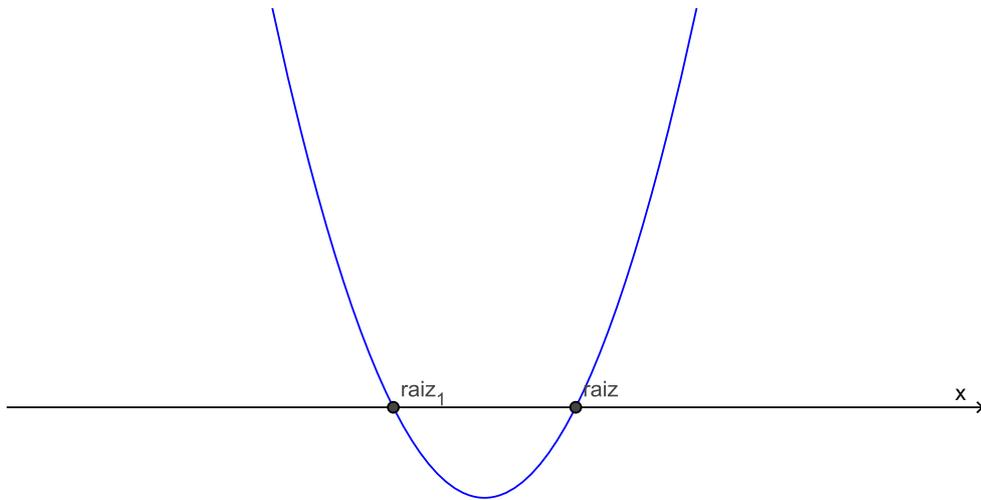
Figura 33 – Com  $a > 0$ ,  $\Delta > 0$ : duas raízes reais e diferentes, concavidade da parábola voltada para cima.
