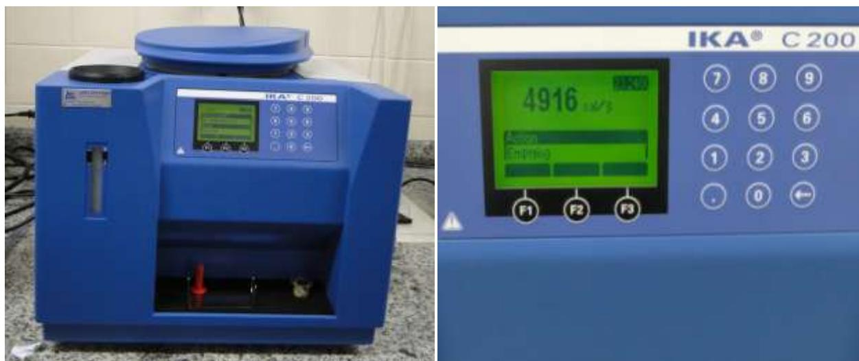
**Figura 4.** Bomba calorimétrica IKA modelo C-200 utilizada no estudo, à direita registro de densidade calórica visualizado no monitor do aparelho.
