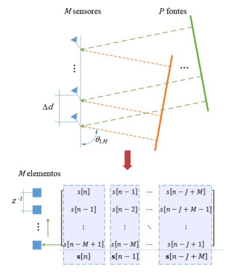
Figura 8 – Relação entre os métodos de subespaços para estimação de ângulos de incidência e estimação de frequência e constante de tempo
