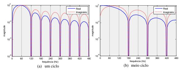
Figura 7 – Resposta em frequência dos filtros STFT
