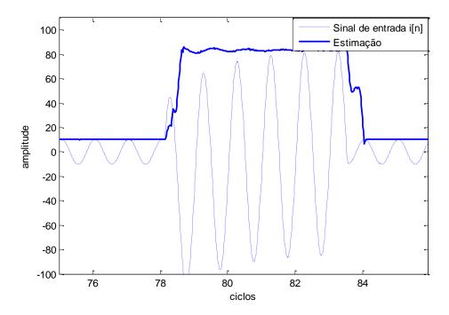
Figura 34 – Simulação com cinco ciclos de falta
