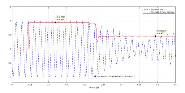
Figura 54 – Simulação de falta a 2500 km da Barra 1: tensão na fase C da Barra 1
