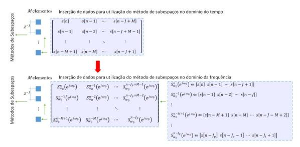
Figura 36 – Relação entre os métodos de subespaços para as aplicações no domínio do tempo e da frequência
