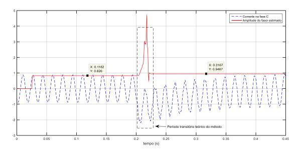
Figura 53 – Simulação de falta a 500 km da Barra 1: corrente na fase C da Barra 1
