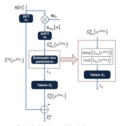
Figura 13 – Diagrama geral do método proposto
