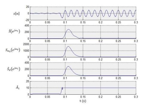
Figura 14 - Variáveis no processo de estimação do método proposto
