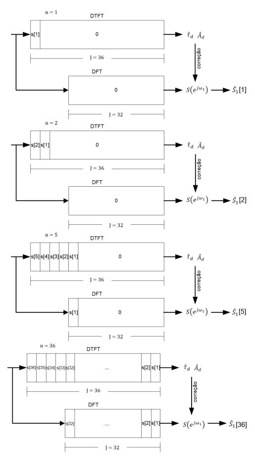
Figura 25 – Fluxograma do método proposto para meio ciclo
