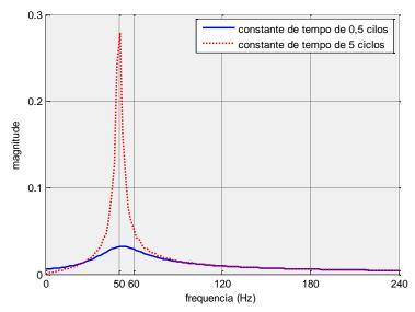
Figura 2 – Espectro de frequências de sub-harmônicos variantes no tempo
