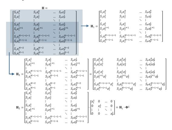
Figura 9 – Desmembramento de H nas submatrizes H<sub>1</sub> e H<sub>2</sub>
