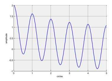
Figura 3 – Componente fundamental e decaimento CC exponencial
