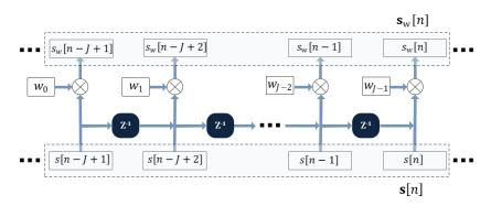
Figura 11 – Multiplicação do sinal s[n] pela janela w
