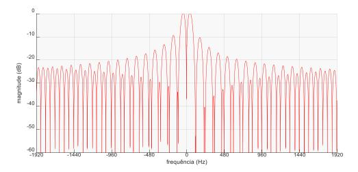
Figura 20 – Espectro da janela proposta com 65 amostras
