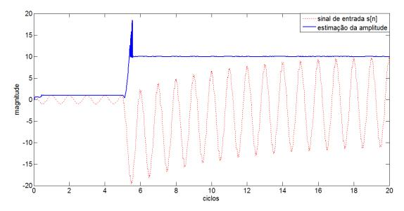
Figura 30 – Simulação no domínio do tempo (estimação de amplitude)
