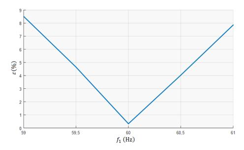
Figura 46 – Desempenho do método frente à variação da frequência fundamental
