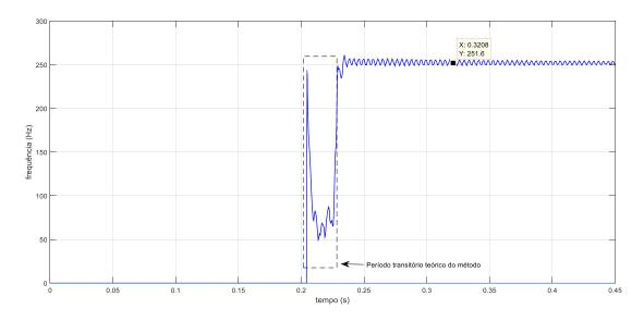
Figura 52 – Simulação de falta a 500 km da Barra 1: frequência no sinal da fase C da Barra 1
