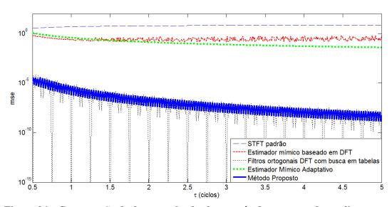
Figura 26 – Comparação de desempenho de alguns métodos encontrados na literatura com o método proposto
