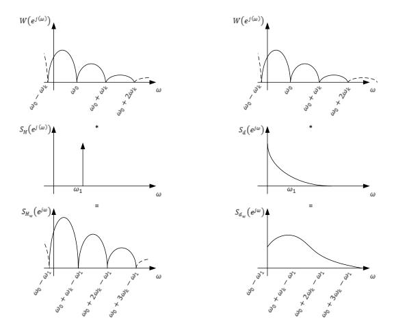
Figura 12 – Convolução entre as DTFTs da janela w e componentes do sinal s[n]
