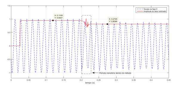
Figura 51 – Simulação de falta a 500 km da Barra 1: tensão na fase C da Barra 1
