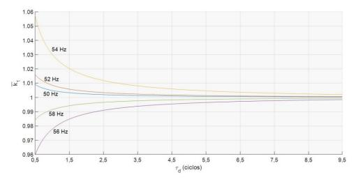
Figura 22 – Exemplos da variável  $k_1$  a partir da variação da constante de tempo
