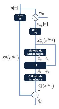
Figura 37 – Diagrama geral do método proposto
