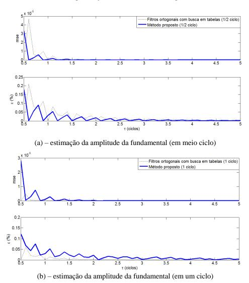
Figura 27 – Desempenho do método proposto e do algoritmo Filtros ortogonais DFT com busca em tabelas frente à presença de decaimento CC exponencial – amplitude
