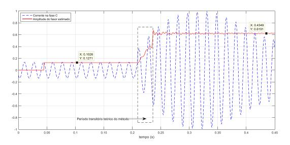
Figura 56 – Simulação de falta a 2500 km da Barra 1: corrente na fase C da Barra 1
