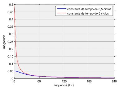
Figura 4 – Espectro de frequências de decaimentos CC exponenciais
