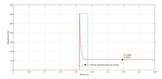
Figura 55 – Simulação de falta a 2500 km da Barra 1: frequência no sinal da fase C da Barra 1
