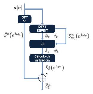
Figura 43 – O método proposto com o algoritmo DFTF ESPRIT
