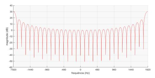
Figura 16 – Espectro da janela proposta com 32 amostras
