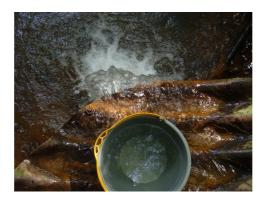
Fotografia 2: Amostragem da vazão. Observe que o córrego é descarregado na margem por um encanamento, localizado no ponto P1.
