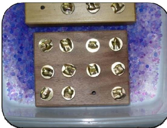
Fig. 12: Espécimes metalizados, armazenados em potes plásticos contendo sílica gel
