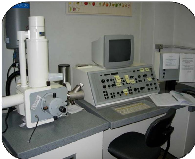
Fig. 13: Microscópio Eletrônico de Varredura DSM 940-A Balzers®
