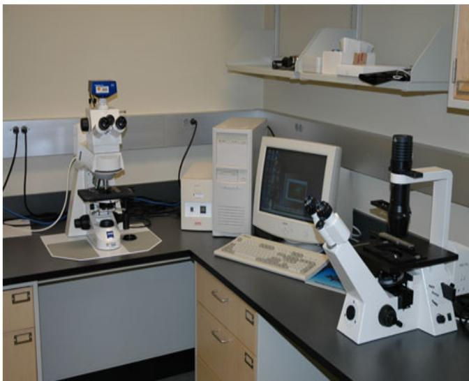
Figura 10 – Sistema óptico Zeiss para captura digital de fotomicrografias.
