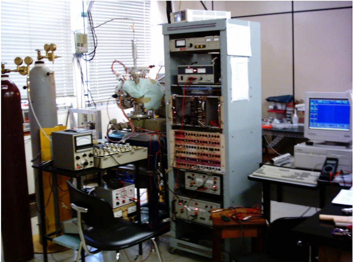
**Figura 3.1:** Espectrômetro de Impacto de Elétrons de Limiares construído no LEAM/UFJF.
