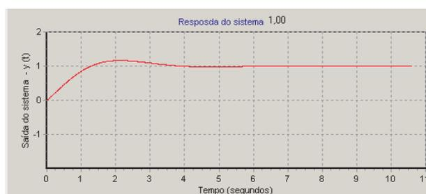
Figura 66: Reposta do processo de pólos múltiplos e iguais para o método do degrau, conforme tabela 20.
