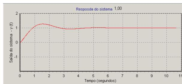
Figura 65: Reposta do processo de pólos múltiplos e iguais para o método de relé, conforme tabela 20.
