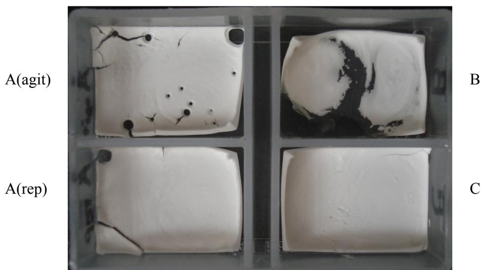
Figura 3.4. Monolitos obtidos por diferentes tipos de agitadores em reservatórios de 1 mL, onde A(agit): agitador magnético; A(rep): agitador magnético, apenas com fase orgânica após repouso (separação da fase aquosa); B: ultra-som e C: Turrax®.
