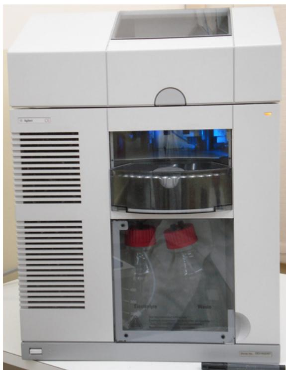
Figura 2.3. Equipamento de Eletroforese Capilar.
