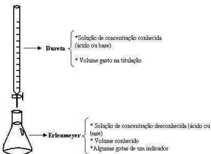
Ao abrir a torneira da bureta, começará a reação entre o ácido e a base. A titulação termina quando é evidenciada a mudança de cor da solução do erlenmeyer.
