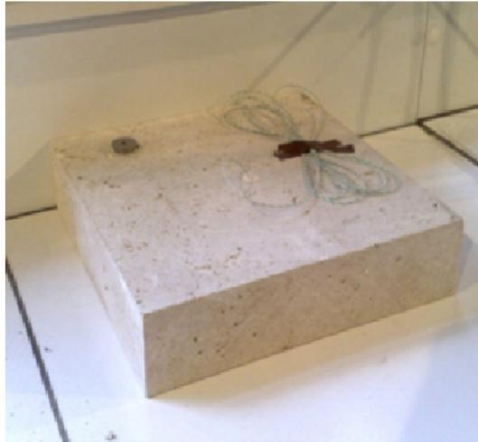
Figura 3.2: Camada de rocha sobre a qual foi fabricada a amostra de concreto
