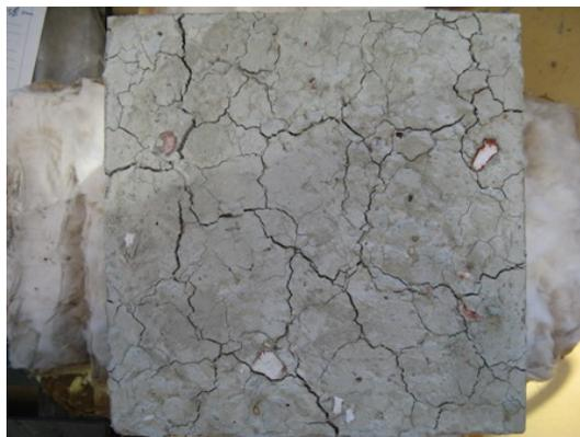
Figura 3.8: Superfície que ficou diretamente exposta ao aquecimento do CC-750
