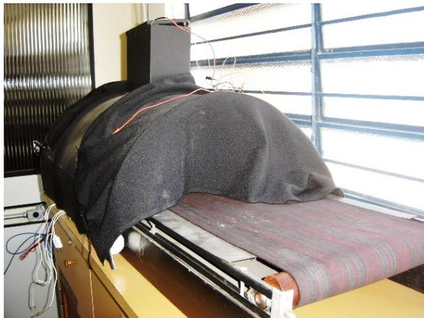
Figura 5.13: Câmara escura utilizada para controlar a iluminação do ensaio
