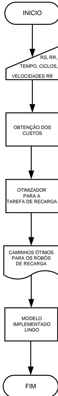
Figura 43 – Fluxograma: otimização para os robôs de recarga
