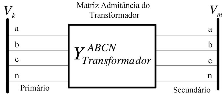
Figura 2.11– Modelo do transformador trifásico
