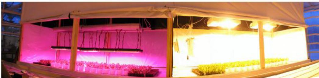
Figura 16: Vista panorâmica de dois dos blocos de crescimento composto de luminárias LED (à esquerda) e luminárias de sódio de alta pressão (à direita) (PINHO T. ROSVALL & HALONEN, 2008).
