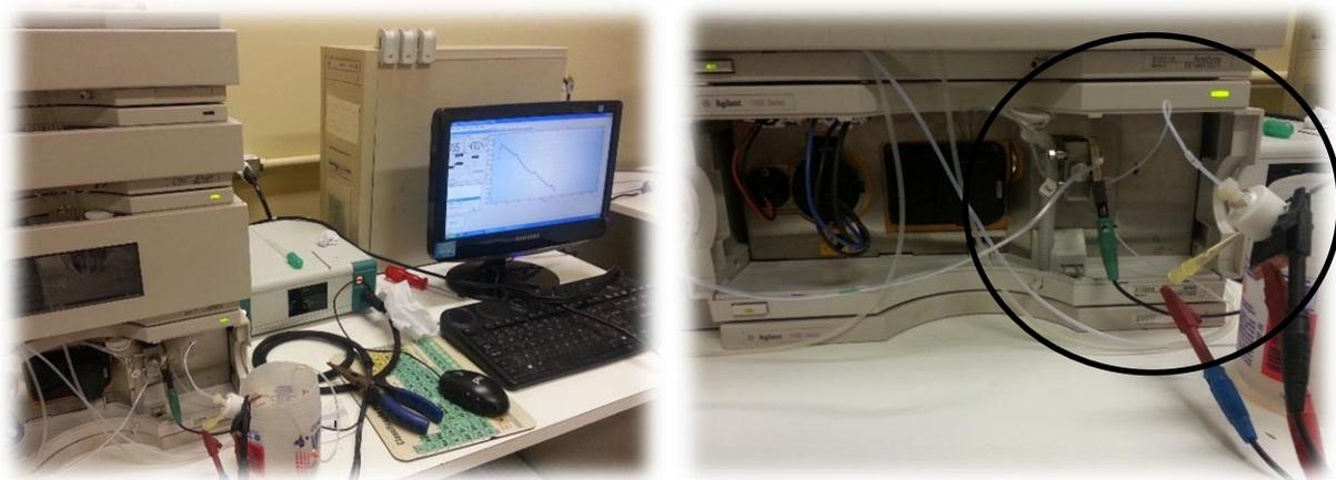
Figura 10 - Microcélula eletroquímica desenvolvida, aplicada em conjunto com o cromatógrafo líquido, adaptada à saída do detector espectrofotométrico do aparelho.
