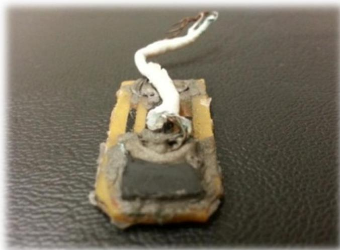
Figura 5 - Segundo eletrodo construído e testado, com a utilização de placa de circuito impresso e cola de prata para estabelecer o contato elétrico entre a placa com o filme de DDB e o cobre utilizado nas trilhas do circuito.
