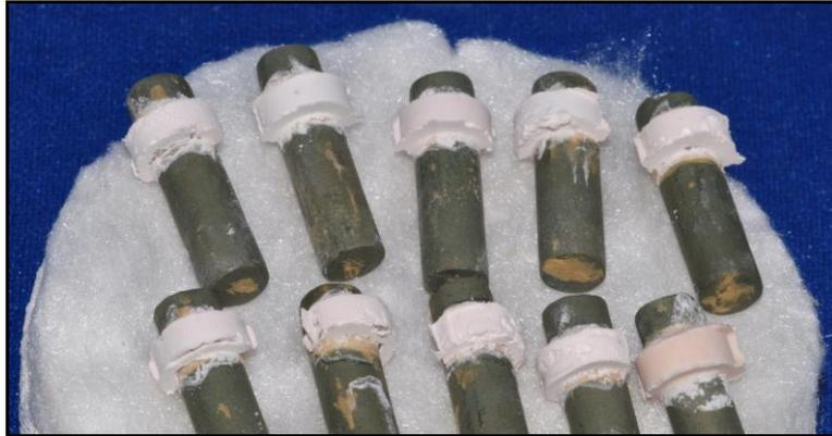
Figura 14 – Amostras de um dos grupos com cerâmica aplicada (VITAVM®13).
