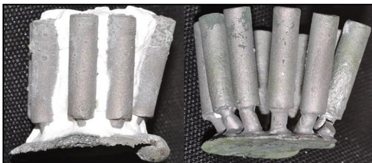
Figura 9 – Amostras de um dos grupos fundidas/desincluídas.
