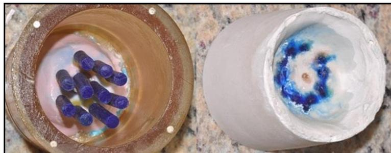
Figura 8 – Cilindros de cera de um dos grupos em anéis de silicone/incluídos.
