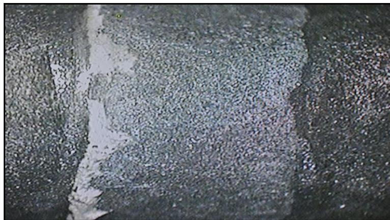
Figura 24 – Padrão de falha adesiva em um dos cp do G2 (Ni-Cr-Ti). Observação em estereomicroscópio (aumento de 50X).
