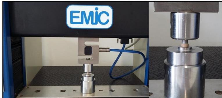
Figura 20 – Momento do ensaio mecânico de cisalhamento.
