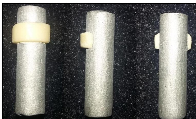
Figura 18 – Vistas de amostra de um cp pronto para o ensaio mecânico.
