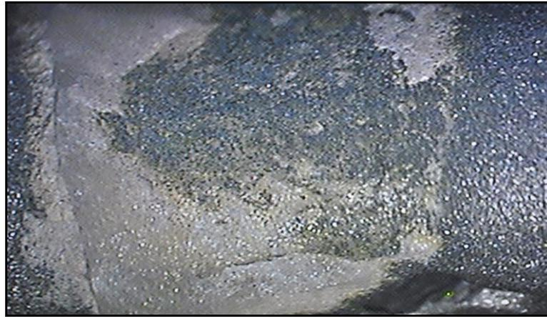
Figura 27 – Padrão de falha mista em um dos cp do G3 (Co-Cr). Observação em estereomicroscópio (Aumento de 50X).
