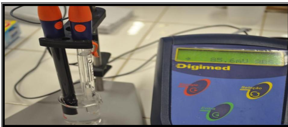
**Figura 4.** Leitura no Potenciômetro acoplado aos eletrodos de referência (cor preta) e eletrodo de íons seletivo (cor transparente).
