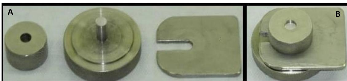
**Figura 1.** Matriz em aço inox utilizada no estudo. (A) Partes constituintes da matriz: anel, base e garfo; (B) Ao montar o garfo com espessura de 2mm forma-se uma cavidade central da matriz, onde são produzidos os corpos de prova.
