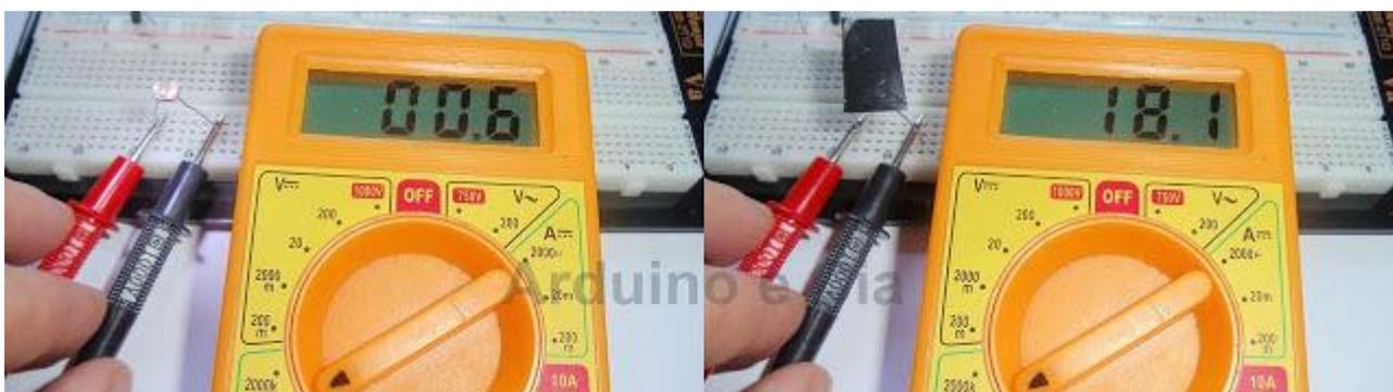
**Figura A27 .** Exemplo prático do LDR com e sem a incidência da luz.
