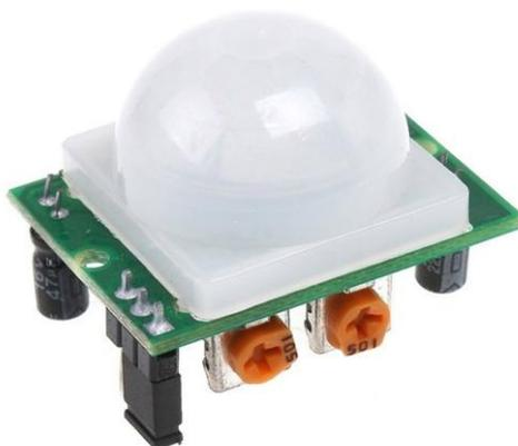
**Figura A21:** Modelo do sensor PIR utilizado no Arduino
