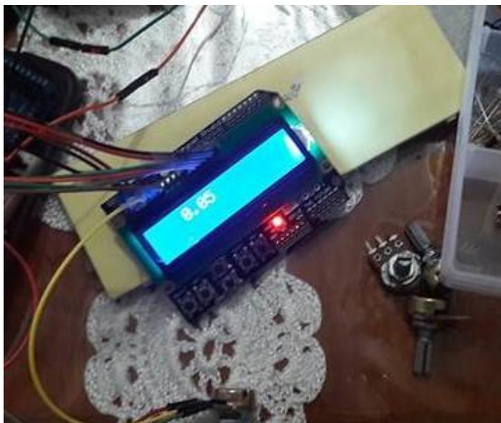
**Figura A 19.** Exemplo do funcionamento do sensor de corrente ACS 712
