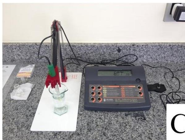
A: Grupos formados para exposição a diferentes condições de armazenagem; B: Centrifugação das amostras; C: Avaliação do pH com potenciômetro.
