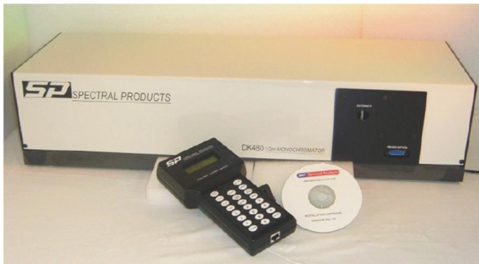
**Figura 4.14:** Monocromador DK480 com seu controle externo e o cd de instalação do programa.
