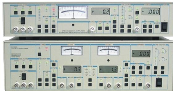
**Figura 4.19:** Amplificador *Lock-in* SR530, *Stanford Research Systems*.
