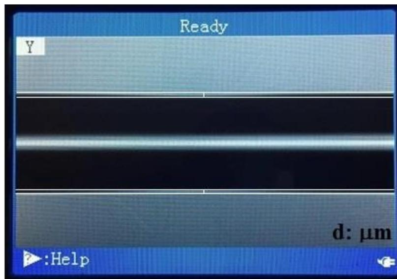
Figura 41 – Modulação geométrica induzida na fibra óptica.
