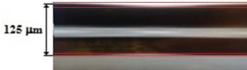
Figura 59 – Microfotografia da *LPG* utilizada no dispositivo de sensoriamento.
