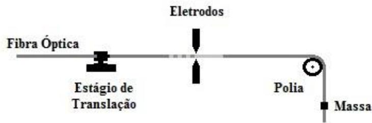
Figura 39 – Representação do setup de fabricação de *LPGs* por arco elétrico.
