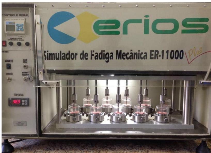
Figura 8 - ERIOS, Modelo: ER-11000 - Simulador de fadiga
