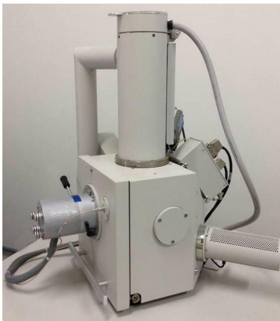
Figura 12 - Microscópio eletrônico de varredura
