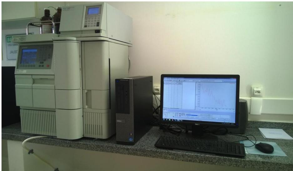
Figura 16: Cromatógrafo Líquido de Alta Eficiência (Waters, modelo Alliance).
