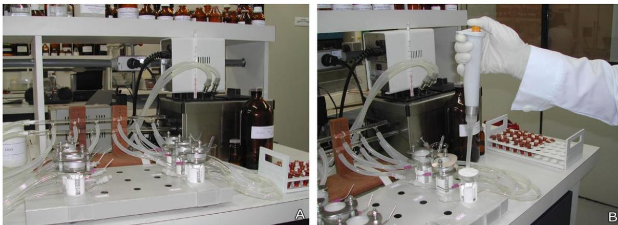
Figura 19: A) Sistema empregado nos estudos de penetração/permeação *in vitro*. B) Aplicação da amostra.
