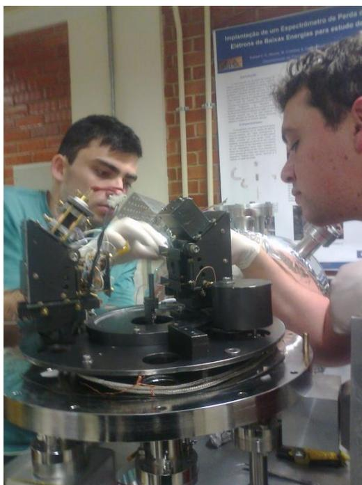
**Figura 3.16:** Espectrômetro de Perda de Energia de Elétrons, com uma fonte gasosa móvel.
