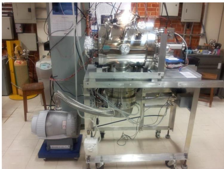
**Figura 3.17:** Sistema de Vácuo do EPEE.
