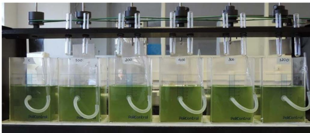
Figura 27 – Experimento de *jar-test* com concentração de Poli-Cloreto (PAC) fixa ( $2 \text{ mg Al L}^{-1}$ ) e um gradiente de concentrações de Solo Vermelho (RS) (100, 200, 400, 800 e  $1200 \text{ mg L}^{-1}$ ).
