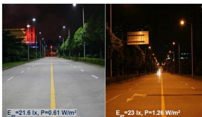
Figura 7. Foto de uma via iluminada com LED (à esquerda) e VSAP (à direita). (TECNOWATT/SIMON LIGHTING).
