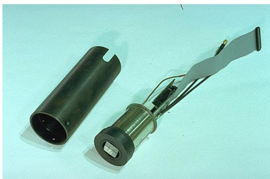
Figura 2.21: O bloco PMT usado no TileCal. Extraído de [9]
