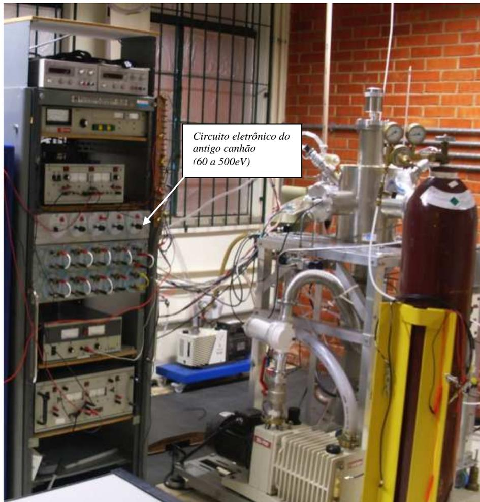
**Fig. 3.13:** Vista do antigo aparelho de SCT, onde se pode ver o circuito eletrônico anteriormente utilizado para o controle do canhão que cobre a faixa de energia de 60 a 500 eV.
