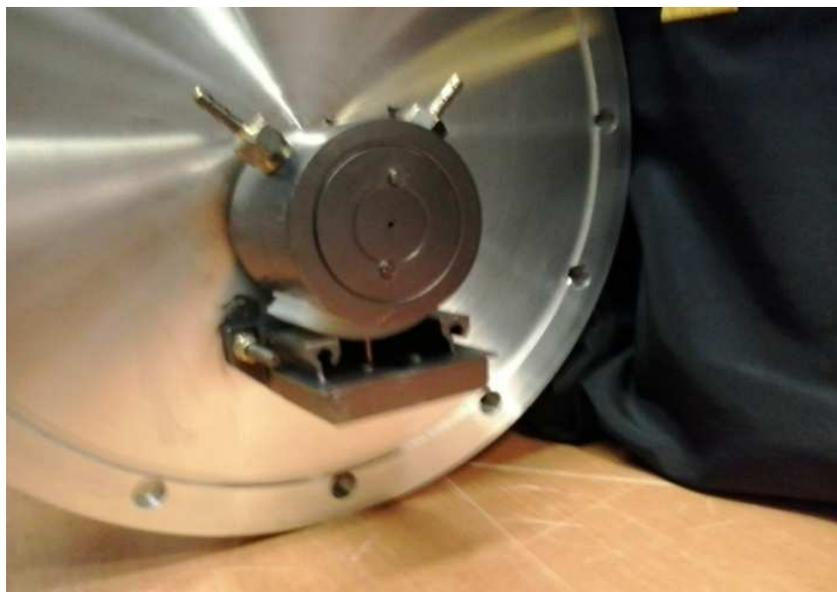
**Fig. 3.15:** Nova célula gasosa utilizada no aparelho de medidas de SCTs, com seu comprimento reduzido para se trabalhar em baixa energia.
