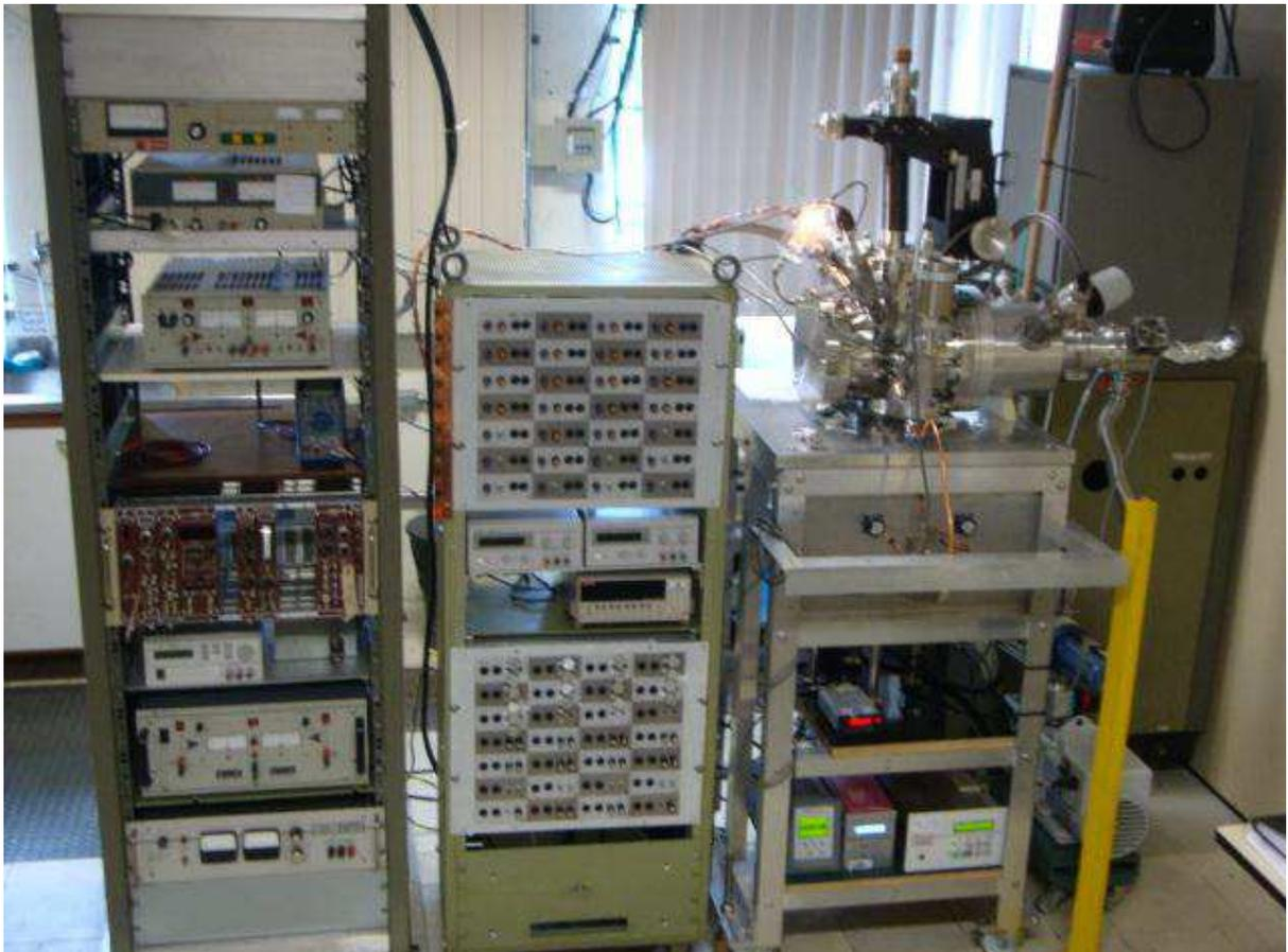
**Fig. 3.2:** Novo aparelho de medidas de Secções de Choque Totais do espalhamento de Elétrons por alvos gasosos, construído para trabalhar em regiões de energias mais baixas.
