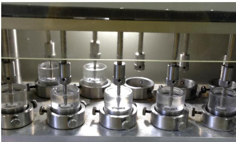
Figura 3: vista frontal das amostras durante o ensaio de ciclagem mecânica em máquina simuladora de fadiga mecânica.
