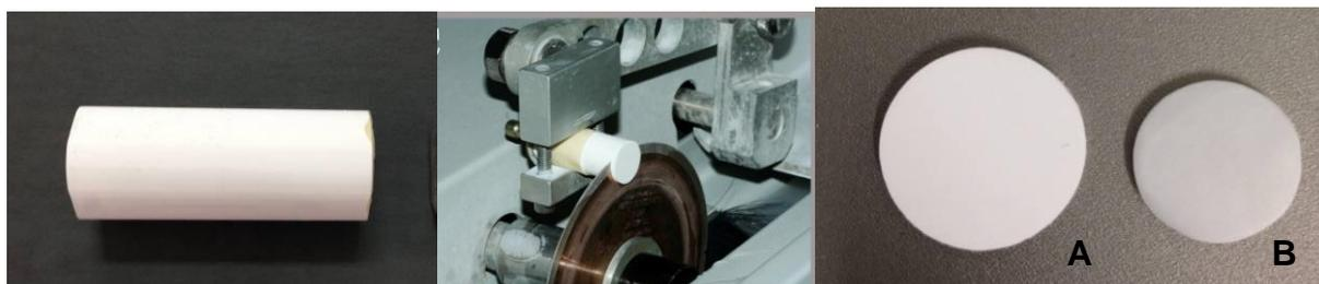
Figura 1A: fotografia do bloco arredondado, B: fotografia do bloco montado na cortadeira durante o corte com disco diamantado e C: amostras em forma de discos antes (A) e após (B) a sinterização.
