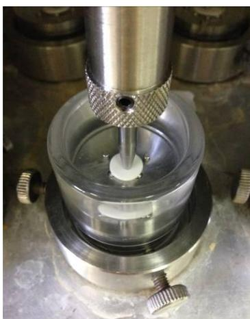
Figura 2: amostra no dispositivo com água destilada.
