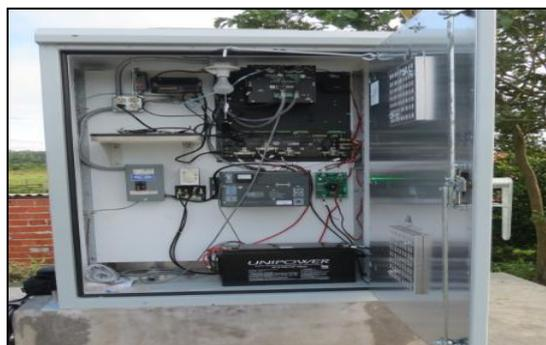
**Figura 2-5 - Hot Box - Circuito de recepção/transmissão**
