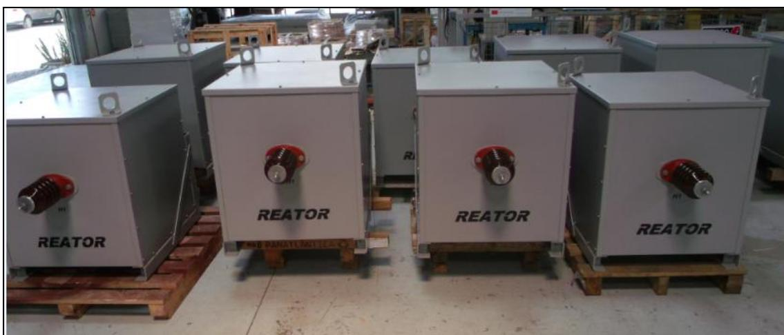
Figura 4-53 - Fabricação dos reatores
