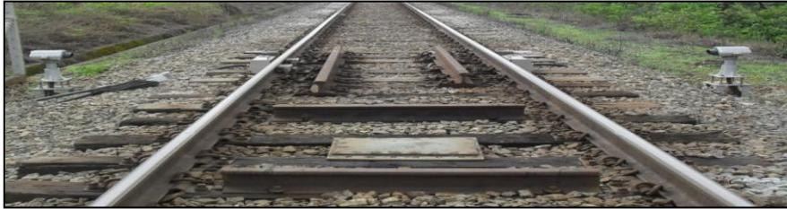
**Figura 2-6 - Hot Box - Sensores**
