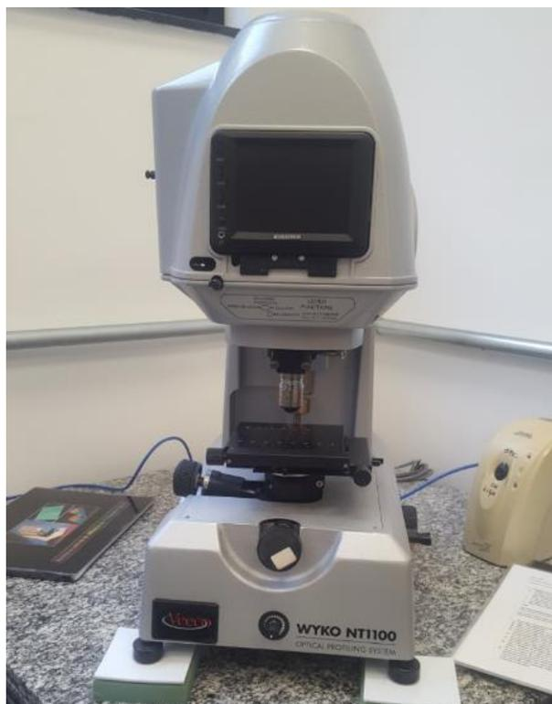
Figura 8 – Perfilômetro óptico digital (LAS-INPE)
