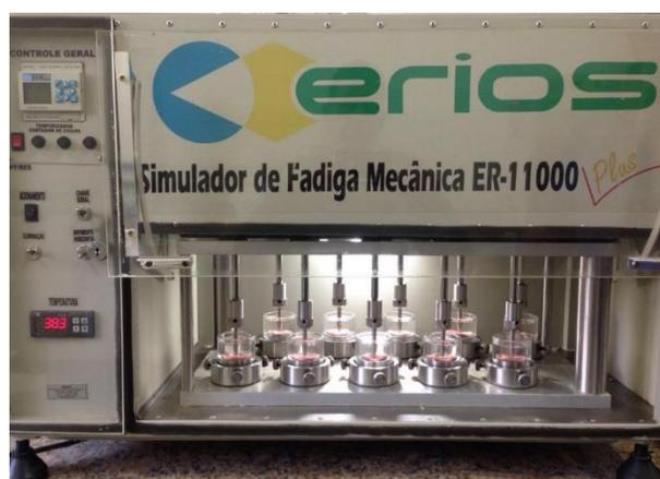
Figura 7 - ERIOS, Modelo: ER-11000 - Simulador de fadiga
