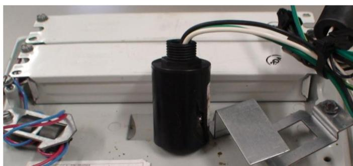
Figura 5.21 Varistor queimado de uma luminária que apresentou mau funcionamento após tempestade.
