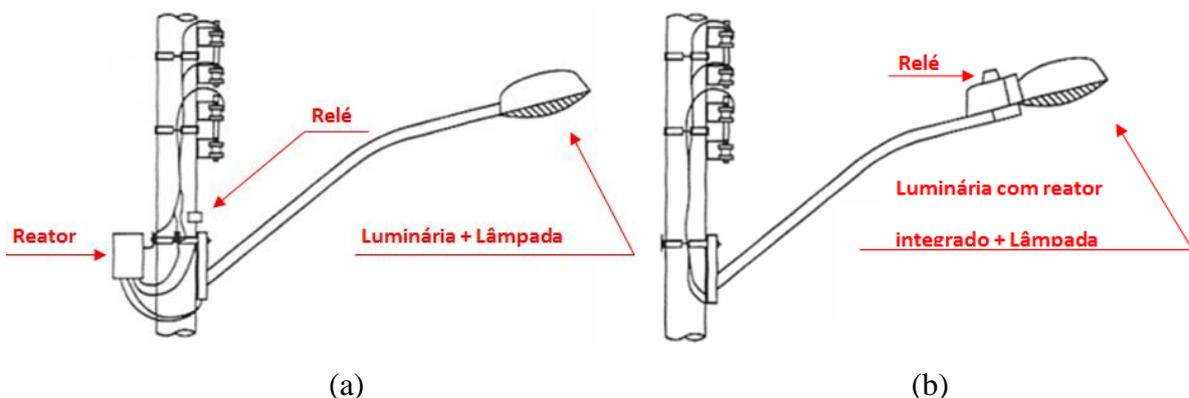
Figura 1.1: Instalação típica de um ponto de iluminação pública com (a) Reator externo e (b) Reator integrado à luminária (RODRIGUES, 2012).
