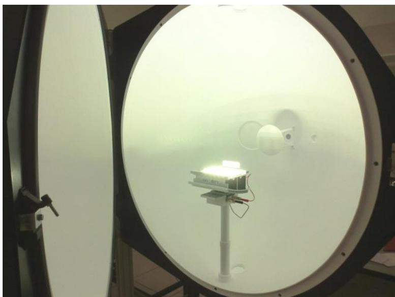
Figura 4.16: Esfera integradora utilizada para a obtenção dos resultados fotométricos.
