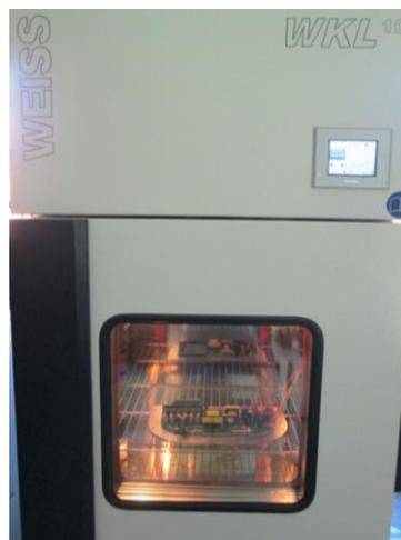
Figura 4.10: Câmara climática com um driver de luminária LED em seu interior.
