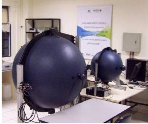
Figura 3.17: Esferas integradoras de Ulbrich.
