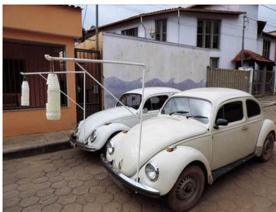
Figura 29. Veículos equipados com suportes para colocar os abrigos de isopor com os termômetros de mercúrio.
