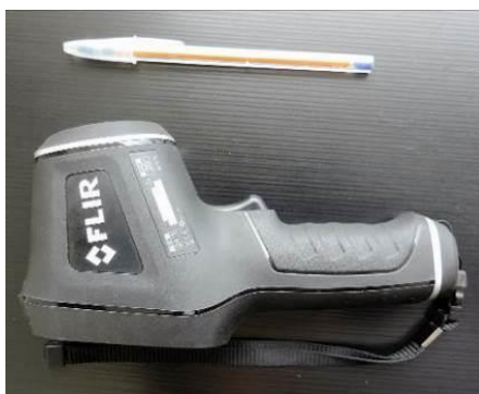
Figura 23. Câmera térmica pontual utilizada para obter a temperatura de superfície. Foto: Rafael de Souza Alves, abril de 2018.
