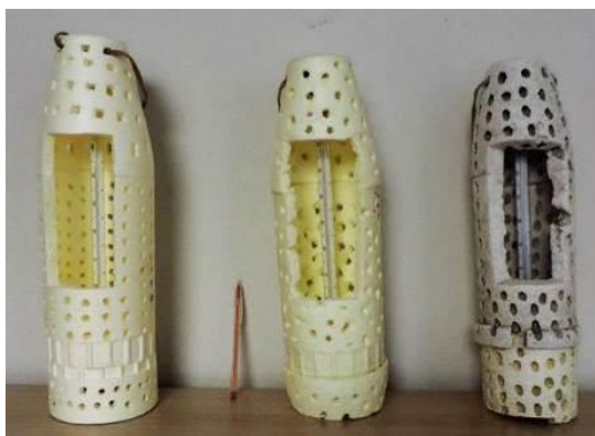
Figura 26. Abrigos de isopor para os termômetros convencionais de mercúrio. Foto: Rafael de Souza Alves, 2017.
