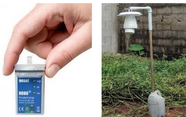
Figura 30. Termômetro com datalogger da marca Hobo, abrigo de isopor e suporte para fixação em campo.
