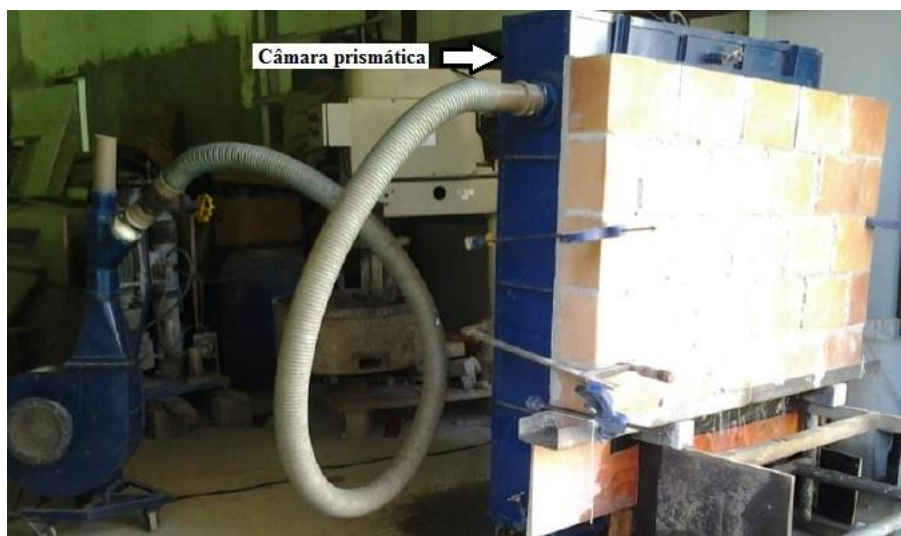
FIGURA 3.4: Equipamentos do ensaio de verificação de estanqueidade pela câmara prismática
