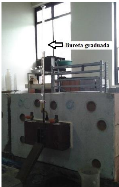
FIGURA 3.6: Execução do ensaio de permeabilidade à água
