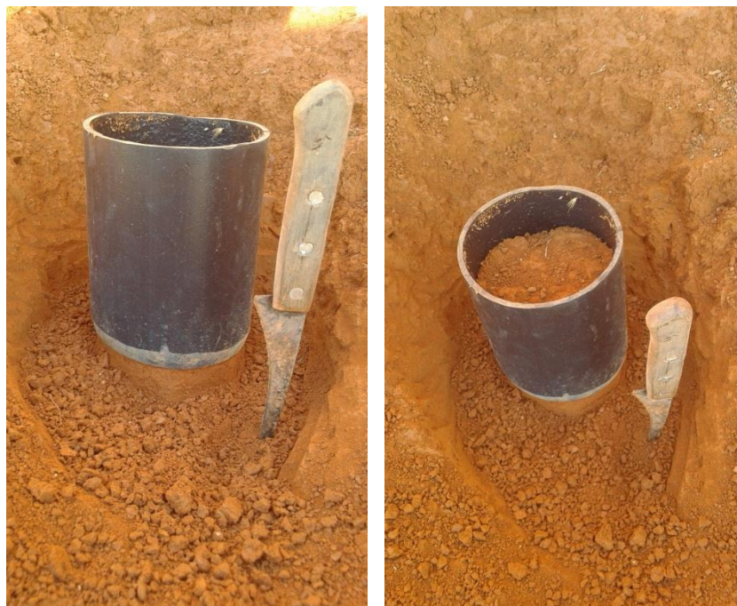
Figura 46: Processo de cravação dos cilindros, durante a coleta das amostras indeformadas (Fonte: próprio autor)
