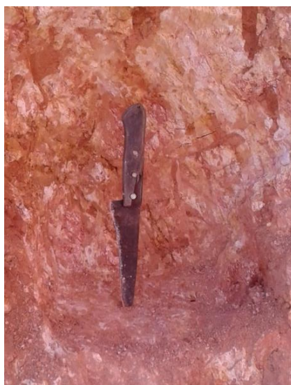
Figura 45: Alinhamento da superfície para a coleta de solo por meio dos cilindros (Fonte: próprio autor).
