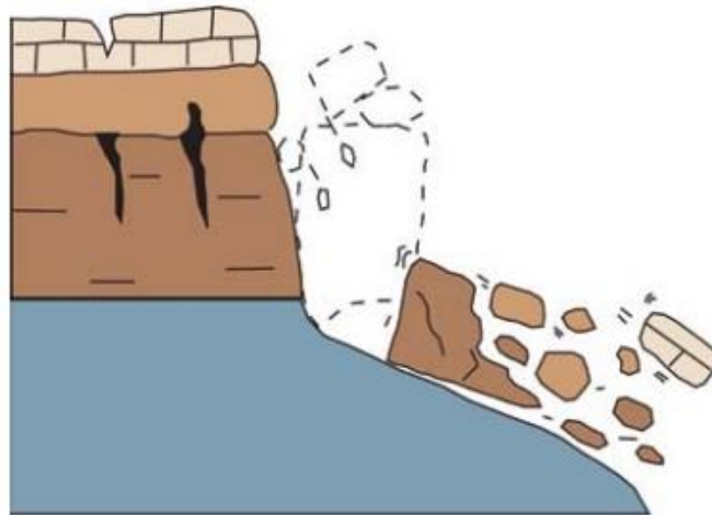
Figura 7: Esquema de Tombamentos de Bloco de Solo e/ou Rocha. Fonte: Highland e Bobrowsky, 2008.
