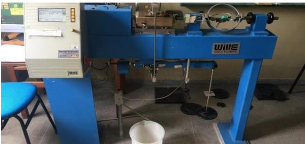
Figura 19: Aparelho utilizado nos ensaios de cisalhamento direto.
