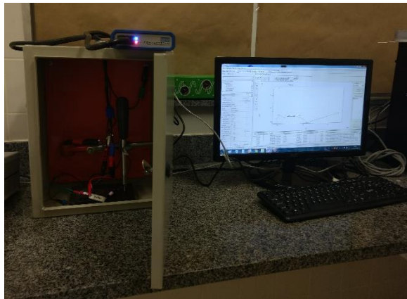
Figura 28: Equipamento utilizado para o estudo da EIS. Destaque para a gaiola de Faraday com o objetivo de isolar eletricamente do ambiente o sistema a ser medido
