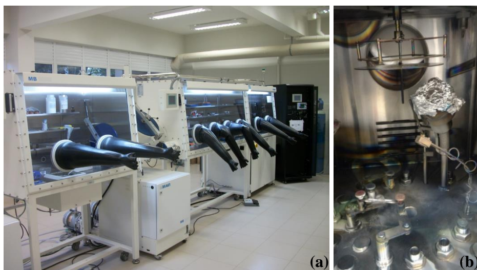
Figura 14: Parte do Laboratório de Eletrônica Orgânica. Em (a) Glove boxes dos sistemas de deposição e em (b) câmara de deposição com os sistemas de deposição por Sputtering e evaporação térmica resistiva.
