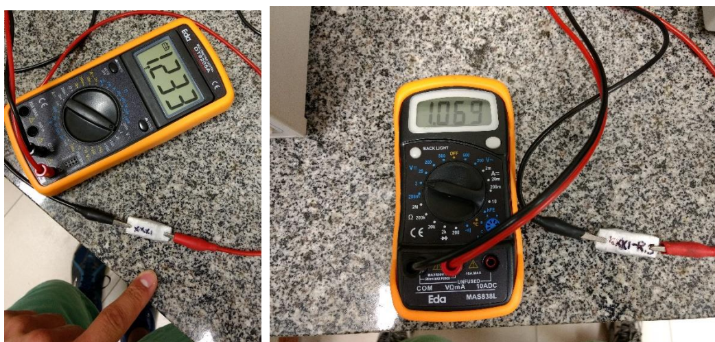
Figura 68: Dispositivos em operação, onde a atual tensão é informada por um multímetro.
