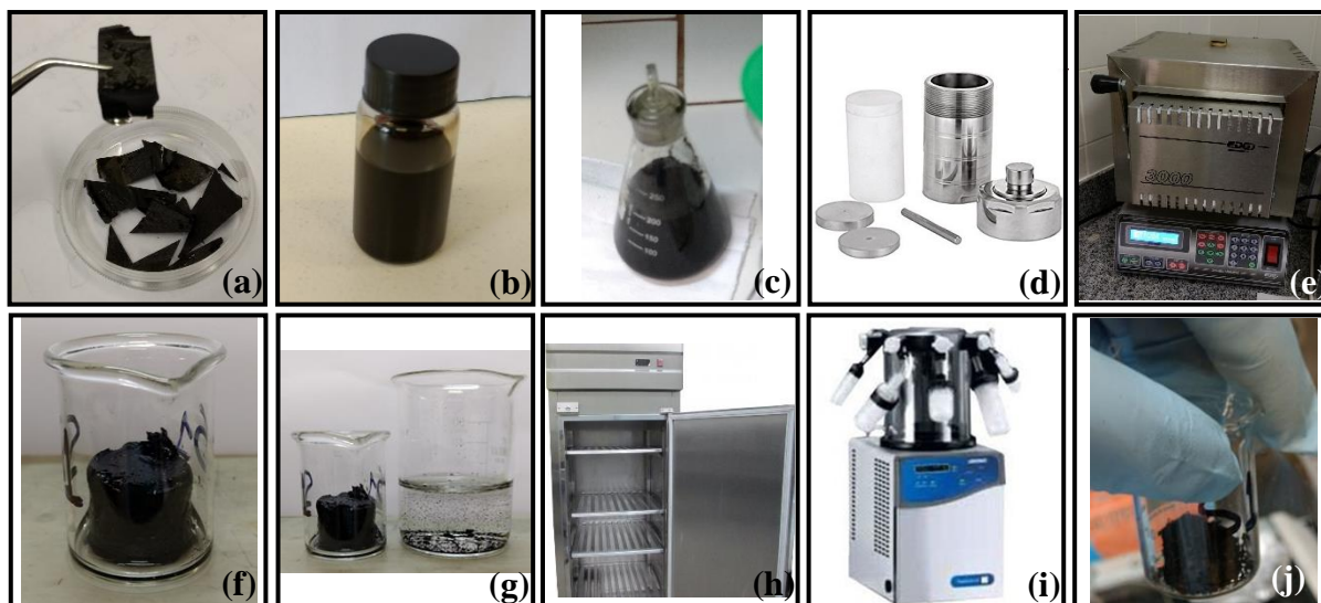
Figura 12: Síntese do Aerogel de Óxido de Grafeno. Em (a) folha de GO seco; (b) solução de 5mg/ml de GO em H 2 O; (c) solubilização do C 6 H 8 O 6 na solução de GO; (d) exemplo de autoclave utilizada na reação; (e) mufla utilizada para aquecimento; (f) Aerogel de Óxido de Grafeno após o aquecimento; (g) Aerogel de Óxido de Grafeno após a lavagens com H 2 O; (h) exemplo de freezer utilizado; (i) modelo de liofilizador responsável por sublimar a água e (j) aspecto final do Aerogel de Óxido de Grafeno.
