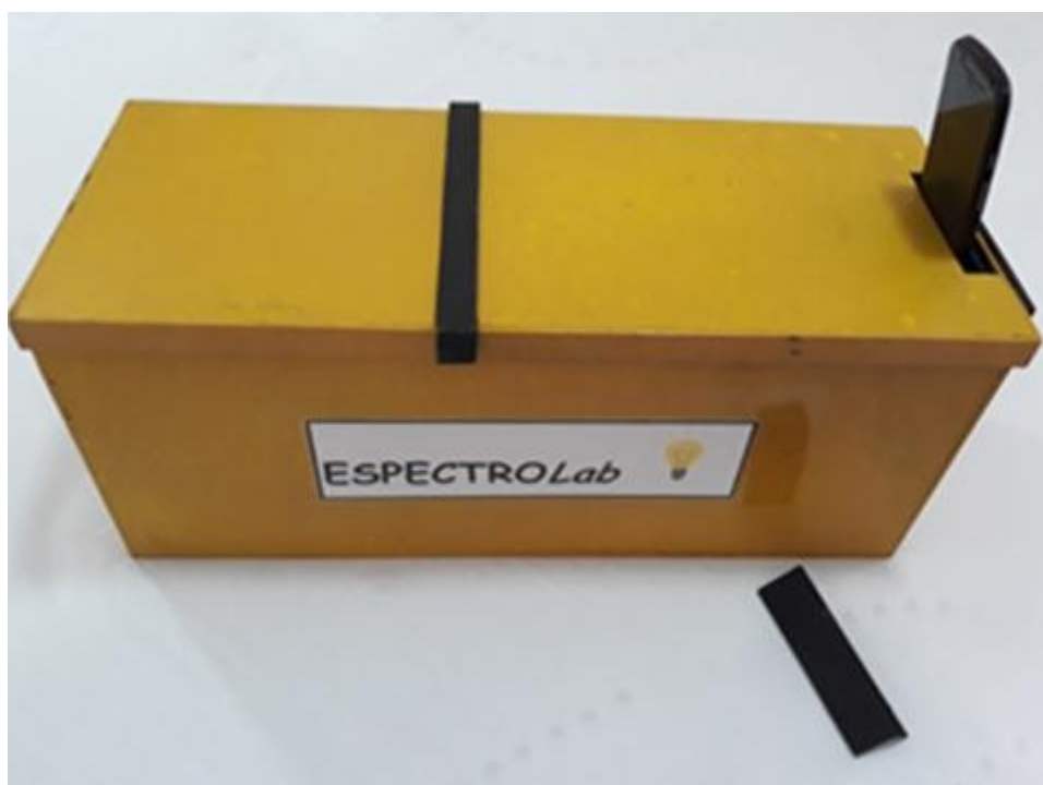
Figura 25: Espectrômetro com celular rodando um aplicativo de luxímetro. Descrição: Montagem criada para medir, de forma padronizada, a luminosidade dos diferentes modelos de lâmpadas. Fonte: Acervo do autor.
