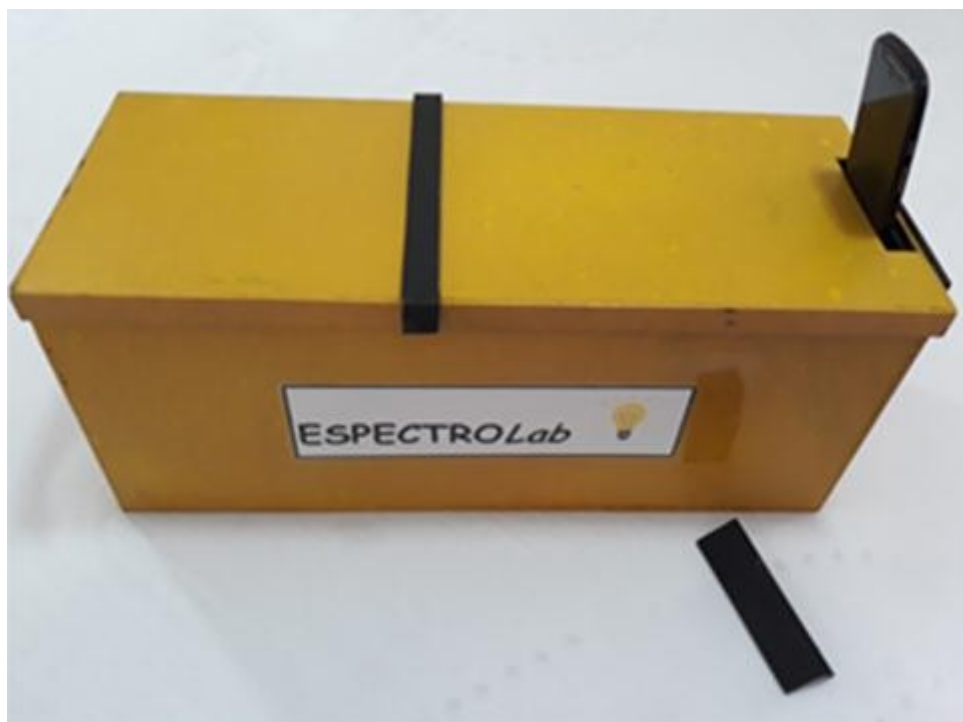
Figura 14: Espectrômetro com celular rodando um aplicativo de luxímetro. Descrição: Montagem criada para medir, de forma padronizada, a luminosidade dos diferentes modelos de lâmpadas. Fonte: Acervo do autor.
