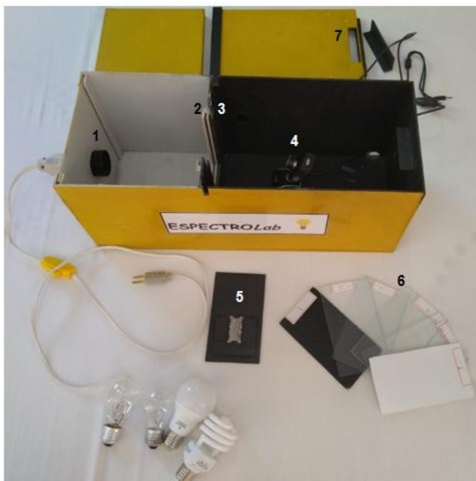
Figura 13: Fotografia do Espectrômetro. Descrição: Espectrômetro de baixo custo, feito em caixa de MDF. Conta com um compartimento para Lâmpadas (1), dois suportes centrais para vidros e fenda (2 e 3), uma webcam conectada a um notebook (4), uma fenda confeccionada com lâminas de barbear (5), vidros (6) e espaço para inserção de um celular rodando um aplicativo de luxímetro (7). Este aparelho possibilita a realização dos experimentos em qualquer ambiente, sem a necessidade de escurecê-lo, além de não incomodar nossos olhos com a luz das lâmpadas. Fonte: Acervo do autor.
