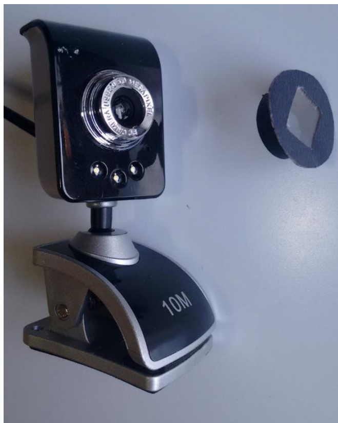
Figura 24 – Webcam com adaptador de rede de difração. Fonte: Acervo do autor
