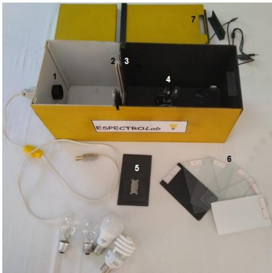
Figura 1: Fotografia do Espectrômetro. Descrição: Espectrômetro de baixo custo, feito em caixa de MDF. Conta com um compartimento para Lâmpadas (1), dois suportes centrais para vidros e fenda (2 e 3), uma webcam conectada a um notebook (4), uma fenda confeccionada com lâminas de barbear (5), vidros (6) e espaço para inserção de um celular rodando um aplicativo de luxímetro (7). Este aparelho possibilita a realização dos experimentos em qualquer ambiente, sem a necessidade de escurecê-lo, além de não incomodar nossos olhos com a luz das lâmpadas. Fonte: Acervo do autor.
