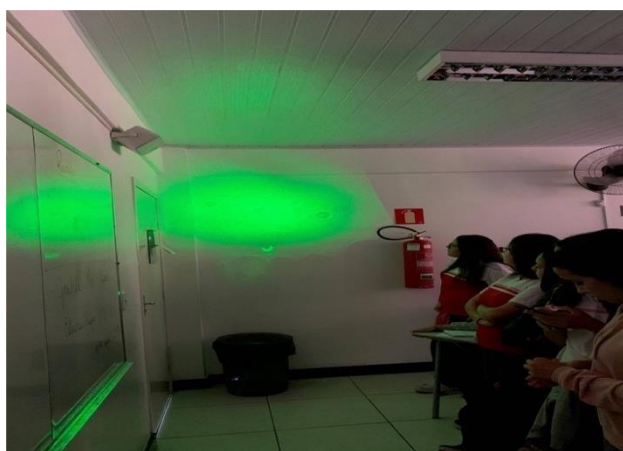
Figura 5 – Alunos observam uma projeção na parede de gota d’água atravessada pelo laser, durante experimento prático 1 - “Análise de micro-organismos presentes em amostras de água”, com resultado positivo para a presença de micro-organismos. Na projeção, os educandos observam protozoários se movimentando entre outras partículas sólidas.
