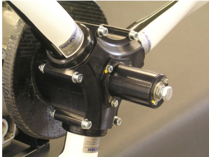
Figura 2 – Detalhe do cubo em uma hélice de passo variável Fonte: https://www.neuform-propellers.com/en/propellers/variable-pitch
