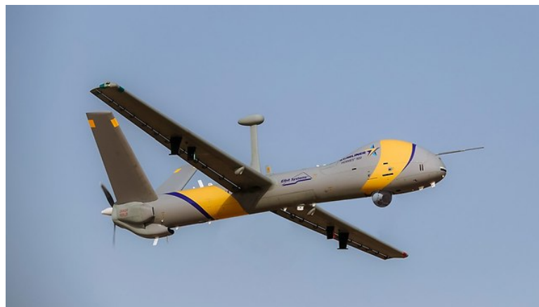
Figura 6 – VANT Elbit para monitoramento de espaço aéreo civil
