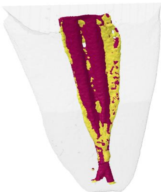
Figura 4 - Reconstrução 3D representativa de micro-CT, tomadas antes (amarelo) e após (vermelho) o PQM, mostrando áreas não preparadas ao longo de todo o canal, relacionadas a Hyflex CM.
