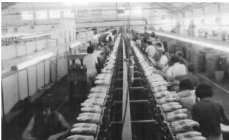
Figura 2: Fabricação sob trilhos
