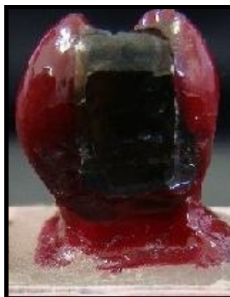
Figura 12: Amostra Impermeabilizada e Impregnada com Nitrato de Prata
