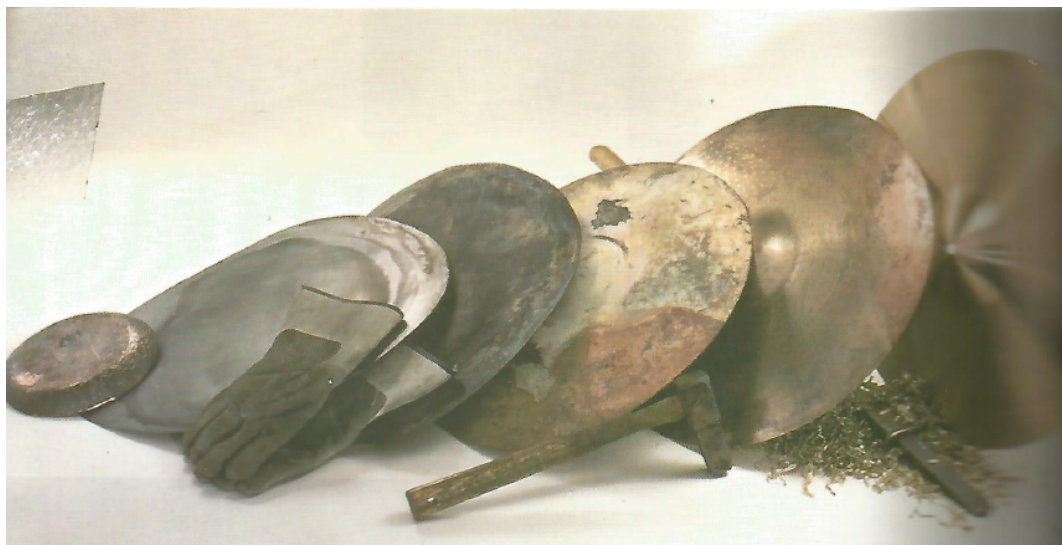
Figura 5 – Etapas de um prato B20. Da esquerda para a direita: a) Lingote. b) Laminado. c) Estampado com cúpula. d) Temperado. e) Martelado. f) Usinado.
